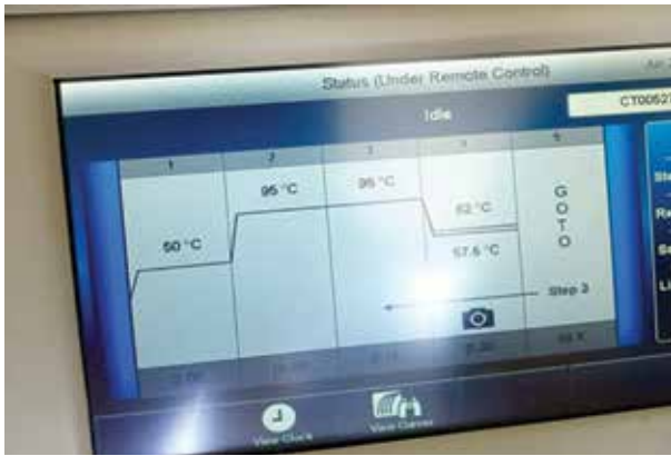
6. ábra: A teszt futtatása előtt látható képernyő, rajta a reakció hőmérsékleti protokolljával
