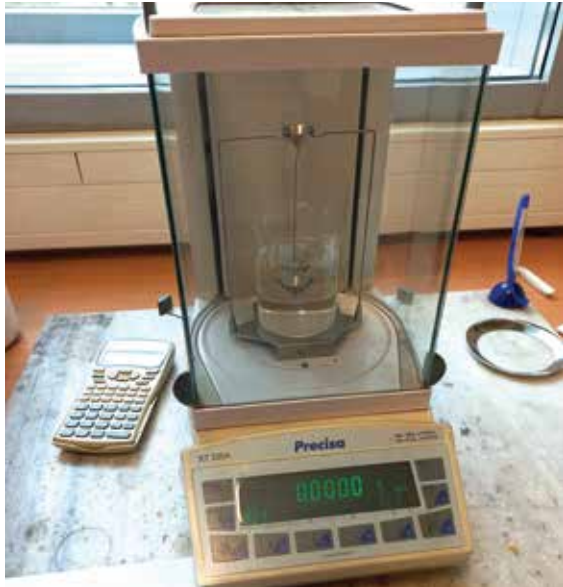
3. ábra: Sűrűségmérés Archimédész módszerrel
