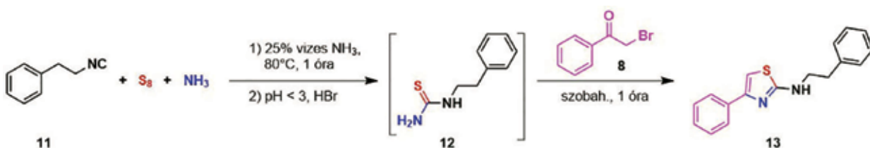
10. ábra: A fanetizol előállítása
