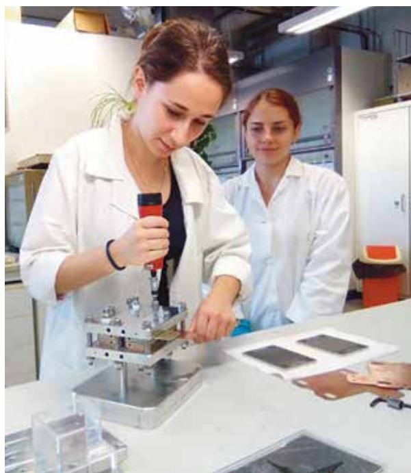
7. ábra: Tüzelőanyag-cella összeszerelése
