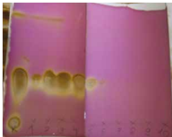
16. ábra A koriander-extraktum oszlopkromatográfiával elkülönített frakcióinak VRK-spektruma
