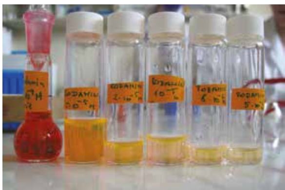
7. kép A rodamin 6G kioldódásának vizsgálatához készített kalibráló sorozat
