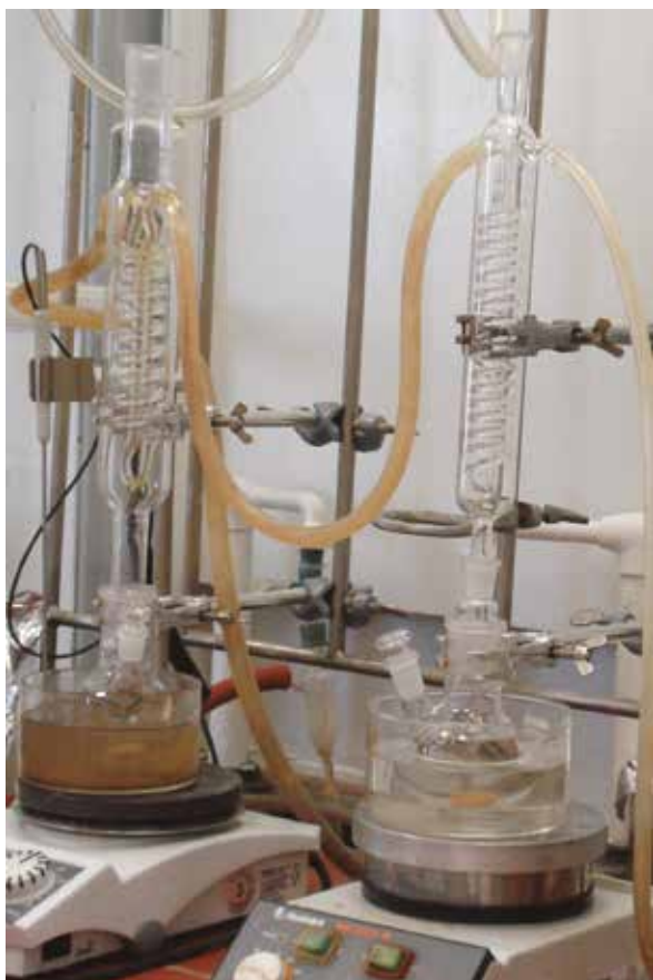
8. ábra Az észterszintézis során az alkohol és a karbonsav fokozatosan alakult észterré
