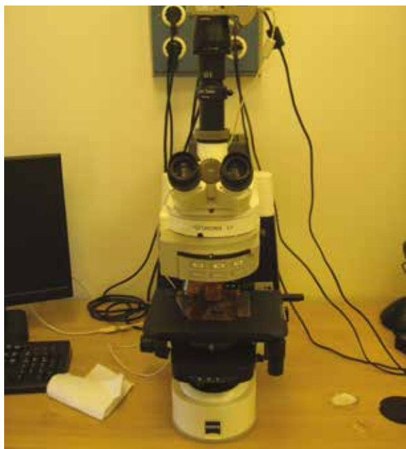
3. kép Optikai mikroszkóp transzmissziós látható és reflexiós ultraibolya fényforrással
