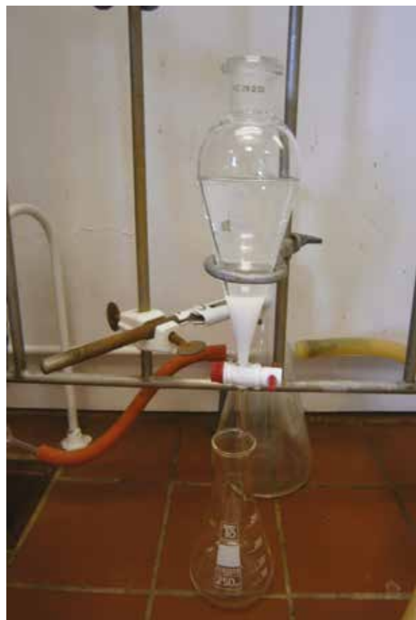
10. ábra A rázótölcsérben jól látszik a fázishatár
