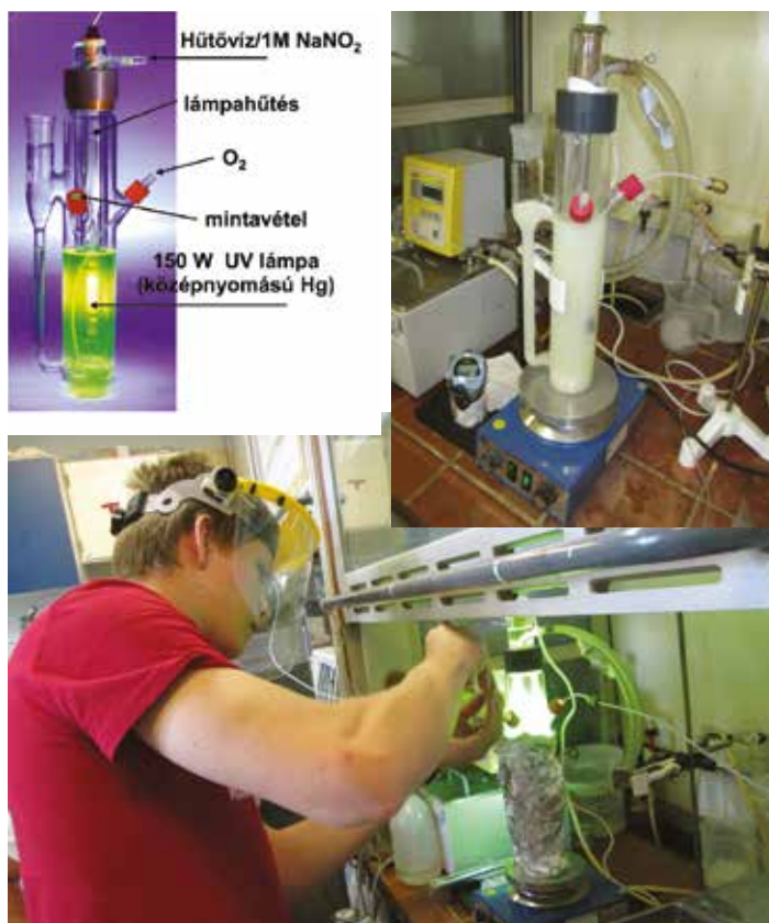
10., 11. és 12. ábra Hereaus fotokatalitikus reaktor
