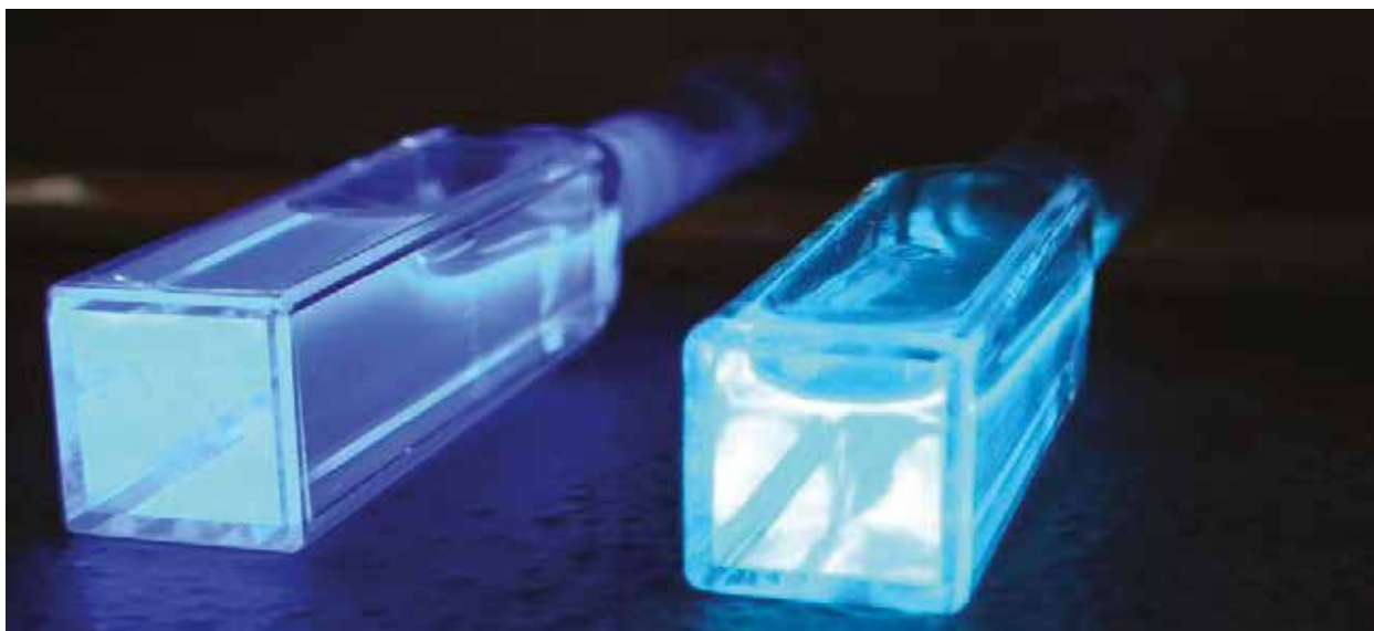
10. ábra A CNBA (bal) és a HFIP-vel képzett komplex (jobb) fluoreszcenciája
