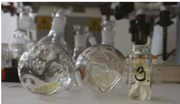
4. ábra Az elkészült szerkezetű polimert alkotó Plexi: 1. lineáris, 2. elágazó, 3. térhálós
