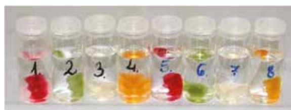
1. ábra Gumimacik oldódásának vizsgálata különböző oldószerben
