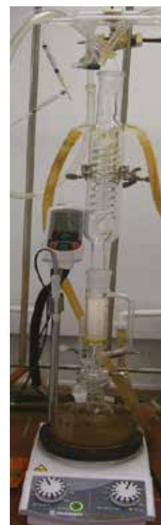
3. ábra A Soxhlet-extraktor felépítése
