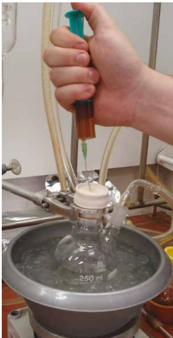
19. ábra A Grignard-reakció felépítése
