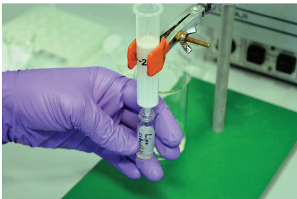
7. ábra A külső puffer lecserélése
