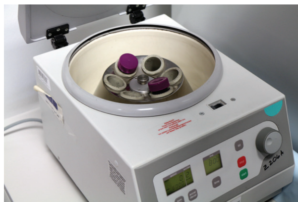
2. Ábra. Az elkészült katalizátor szűrése centrifugálással
