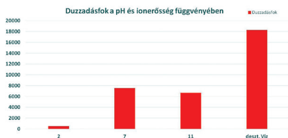
5. ábra Saját polimer duzzadásfoka a pH és ionerősség függvényében
