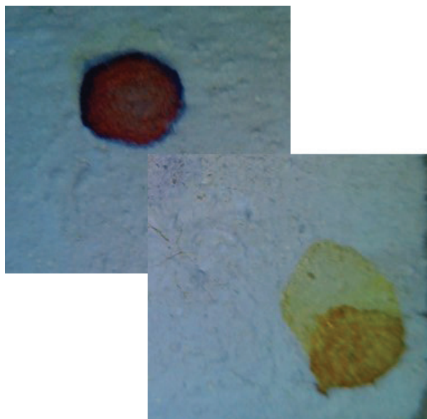
13. ábra Kurkuminnal kezelt \text{TiO}_2 falfesték reagálása nátrium-hidroxidra és ecetsavra.
