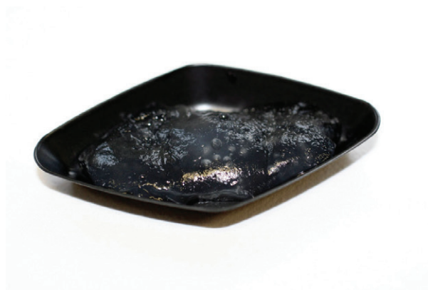
4b. ábra A duzzasztott hidrogél
