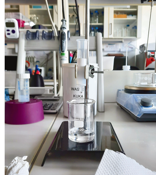
2. ábra: CL-2B méretkizárásos kromatográfás oszlop töltése
