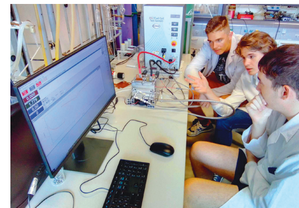
6. ábra: Nyílt áramköri potenciál ellenőrzése
