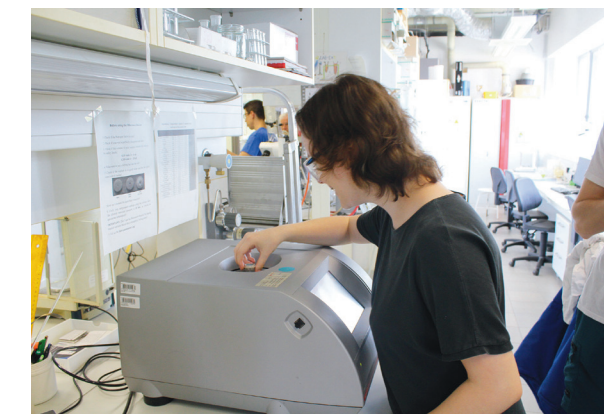
9. ábra: A C-vitamin tartalmú minta behelyezése a mikrohullámú reaktorba
