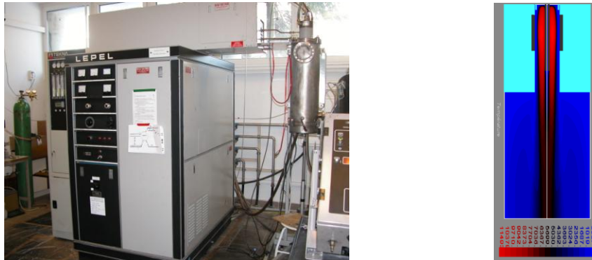
1. ábra Az AKI-ban üzemelő RF plazmarendszer képe és a plazmareaktor hőmérséklet-eloszlása
